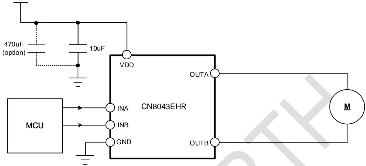
注：当电源电压 VDD 大于 20V 时需在输入端加一个 470 uF 的电解电容防止芯片因电压毛刺过高造成损坏。
